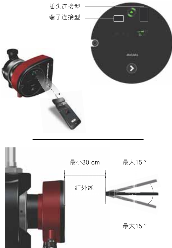
图 29 通过红外通信在格兰富GO和MAGNA1之间建立连接
