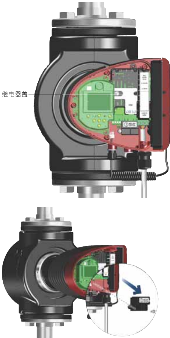
图 34 拆卸继电器盖
